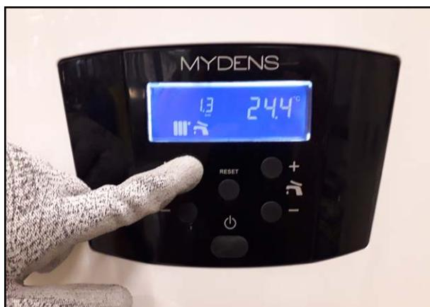
Per terminare totalmente la programmazione, premere nuovamente il tasto “+” del riscaldamento.
